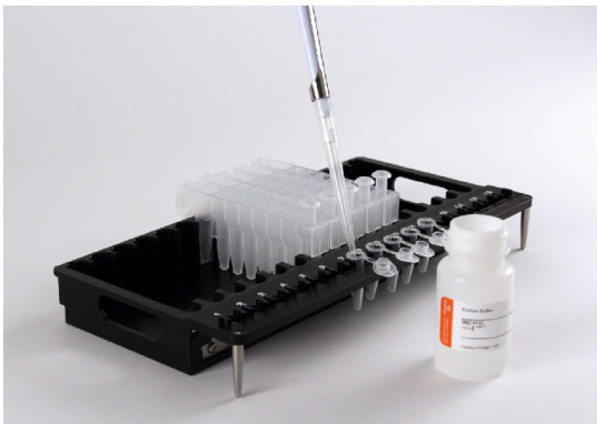
Figura 2. Preparación y configuración de la bandeja de plataforma. Se añade el tampón de elución a los tubos de elución de la manera indicada.
