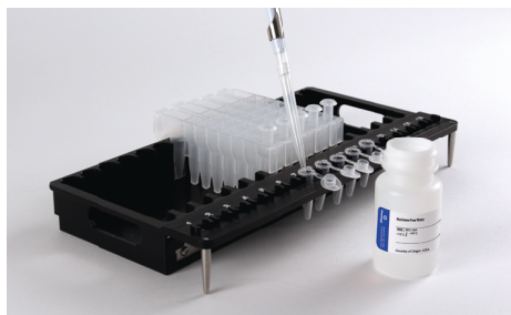
Figura 2. Preparación y configuración de la bandeja de plataforma. Se añade Nuclease-Free Water a los tubos de elución de la manera indicada.
