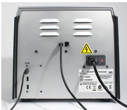
Figura 12. Conecte el Tablet PC a la parte posterior del Maxwell® CSC Instrument.
