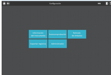
Figura 25. Pantalla “Configuración” de Maxwell® CSC. El botón Administrador solo resultará visible si el operador que tenga iniciada la sesión dispone de derechos de administrador en Maxwell® CSC Software.
