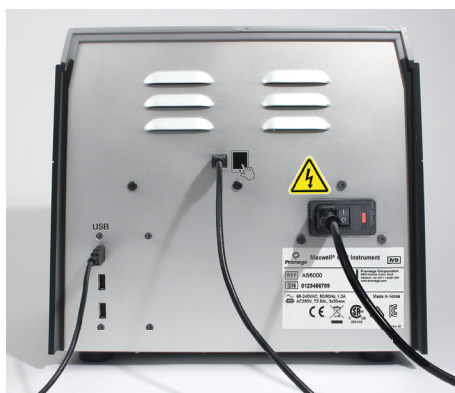
Figura 3. Vista posterior del Maxwell® CSC Instrument. En la parte posterior del instrumento se pueden ver el interruptor de encendido/apagado, el conector del cable de alimentación, el puerto de comunicación USB entre el instrumento y la tableta, y tres puertos de comunicación USB adicionales para la conexión de dispositivos periféricos (por ejemplo, el lector de códigos de barras).
