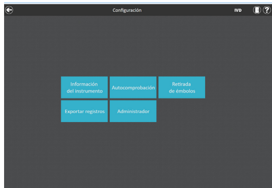
Figura 21. Pantalla de “Configuración” de Maxwell® CSC. Desde esta pantalla, puede realizar el procedimiento Retirada de émbolos para descargar los émbolos que puedan quedar en la barra de émbolos tras ejecutar un protocolo fallido.
