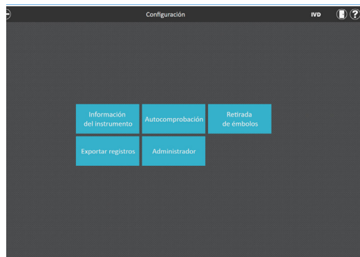
Figura 19. Pantalla de “Configuración” de Maxwell® CSC. Desde esta pantalla, podrá iniciar la función de Autocomprobación del Maxwell® CSC Instruments.
