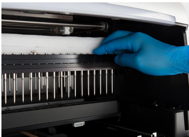
**Figura 60. Deslice las barras de émbolo y de imán hacia abajo e inserte la espuma troquelada superior.**
