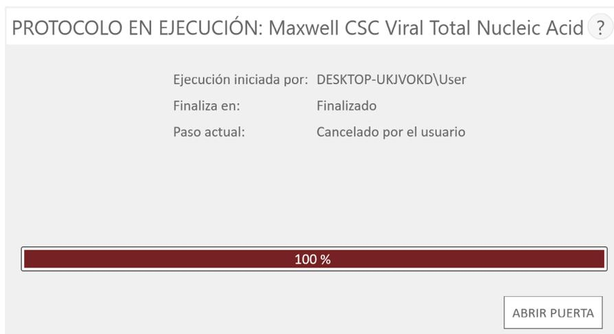
**Figura 47. Pantalla “Protocolo en ejecución” tras la cancelación del usuario.** Si el usuario cancela el método, la pantalla “Protocolo en ejecución” mostrará una barra de progreso del 100 % y Paso actual indica Cancelado por el usuario. Después de que se cancele un método, pulse el botón **Abrir puerta**.
