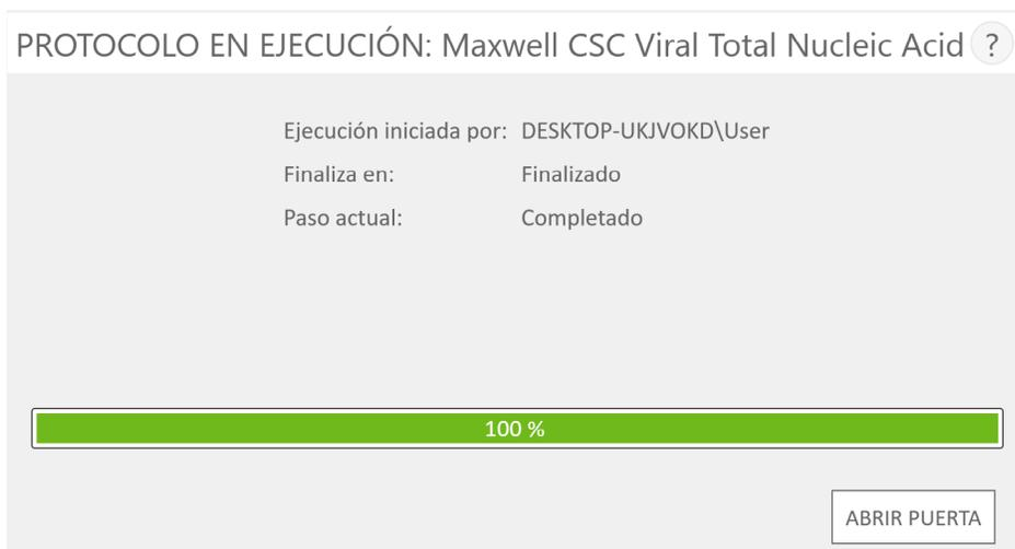
**Figura 43. Pantalla “Protocolo en ejecución” tras completar el método.** Una vez completado el método de extracción que se está ejecutando actualmente, la barra de progreso mostrará un porcentaje del 100 %. Paso actual cambia a Completado una vez finalizada la ejecución. Una vez completado el método, puede tocar el botón **Abrir puerta** para abrir la puerta de Maxwell® CSC 48 Instrument y retirar las bandejas de plataforma.
