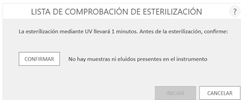
**Figura 57. Pantalla “Lista de comprobación de esterilización”.** La lista de comprobación de esterilización indica el tiempo que tardará la esterilización mediante UV. Confirme que no hay muestras ni eluidos presentes en el instrumento antes de ejecutar la esterilización.
