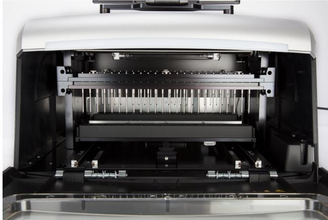
**Figura 4. Plataforma y componentes del sistema magnético.** Los componentes de hardware del interior de Maxwell® CSC 48 Instrument. Se pueden ver claramente las barras de imán y de émbolo, que se usan para procesar las muestras, y la plataforma, que sostiene las bandejas de plataforma.
