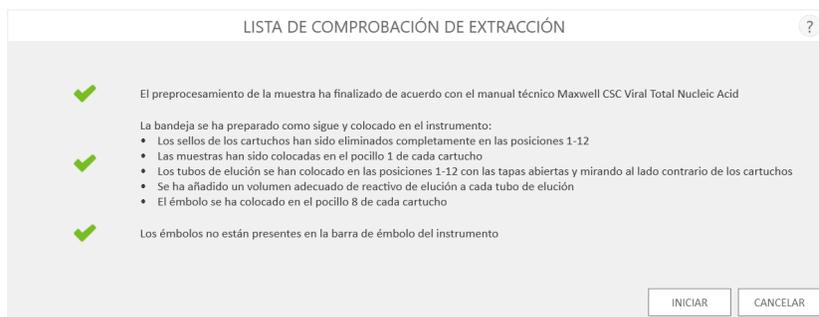
**Figura 40. Lista de comprobación de extracción completada.** Una vez confirmados todos los elementos de la lista de comprobación, se activará el botón **Iniciar**. Toque el botón **Iniciar** para ejecutar el procesamiento o el botón **Cancelar** para volver a la pantalla de introducción de información de las muestras.
