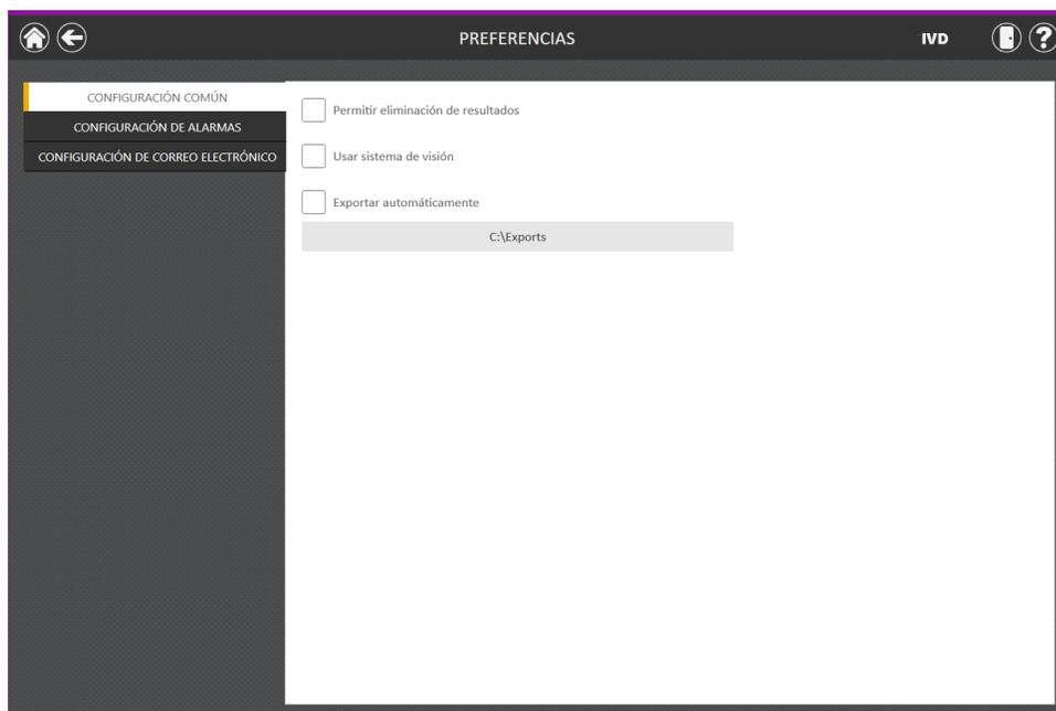
**Figura 26. Pestaña “Configuración común” de la pantalla “Preferencias”.** En la pestaña “Configuración común”, el administrador puede especificar comportamientos del software y de exportación, así como el uso de la cámara con sistema de visión.
