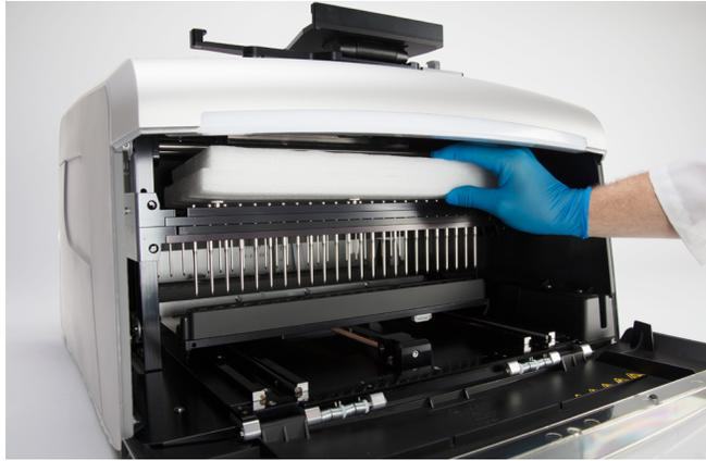
**Figura 61. Colocación de la espuma troquelada superior.**
