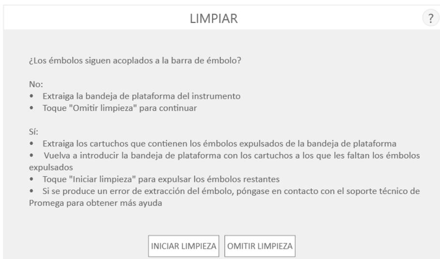
**Figura 48. Pantalla “Limpiar” tras un error del instrumento/cancelación.** Si el usuario cancela un método de extracción o se cancela debido a un error del instrumento y se ha desactivado el sistema de visión, aparecerá la pantalla “Limpiar” y le solicitará **Iniciar limpieza** u **Omitir limpieza**, en función de si sigue habiendo émbolos acoplados a la barra de émbolo.
