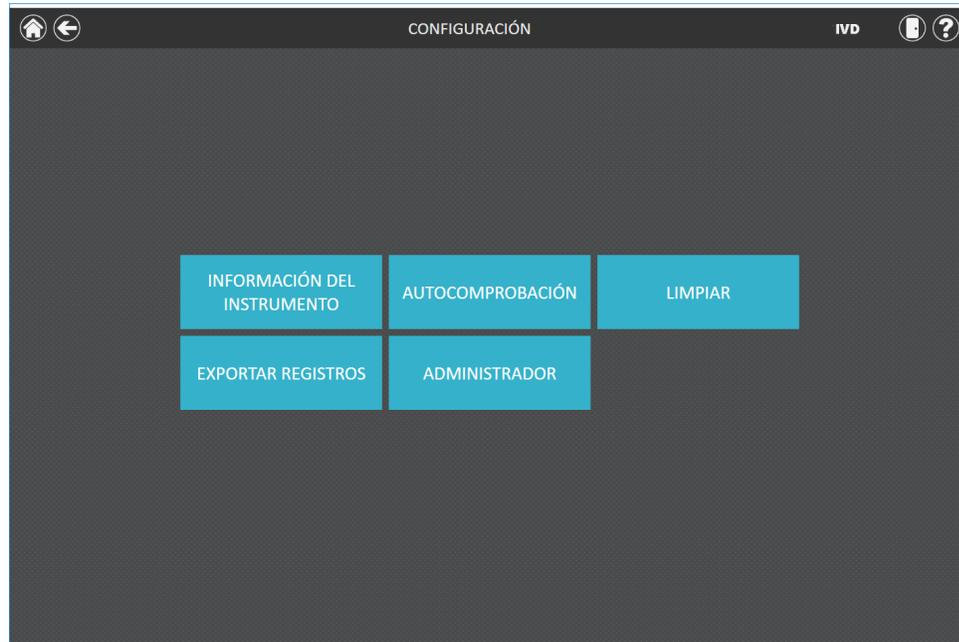
**Figura 21. Pantalla “Configuración” de Maxwell® CSC 48.** El botón **Administrador** solo estará visible si el operador que tenga iniciada la sesión actualmente dispone de derechos de nivel de administrador en el software de Maxwell® CSC 48.
