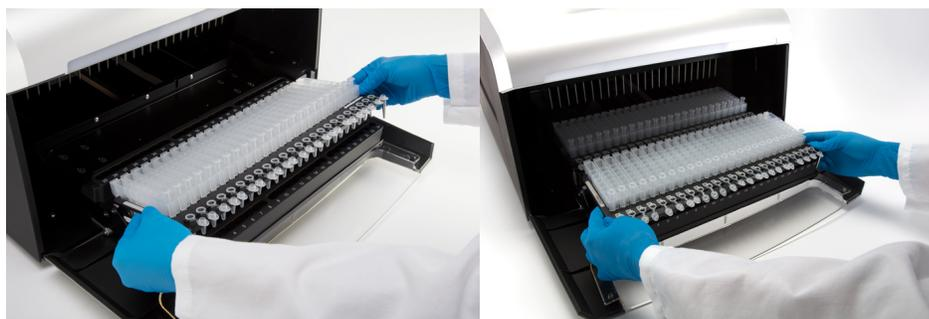
**Figura 41. Colocación de la bandeja de plataforma en el instrumento.**
