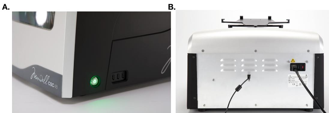
**Figura 3. Vistas laterales y traseras de Maxwell® CSC 48 Instrument. Panel A.** El lateral del instrumento que muestra el interruptor de encendido/apagado y el concentrador USB de 3 puertos para accesorios como el lector de códigos de barras. **Panel B.** La parte trasera del instrumento que muestra el conector del cable de alimentación y el puerto de comunicación USB para el Tablet PC.
