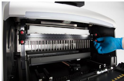
**Figura 7. Extracción de las dos piezas de espuma del interior del instrumento. Panel A.** Extraiga la pieza de espuma frontal. **Panel B.** Extraiga los cuatro tornillos de envío de los lados de las barras de imán y de émbolo frontales.
