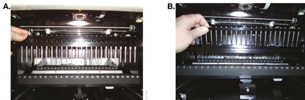
**Figura 59. Extracción del sistema frontal de varillas magnéticas. Panel A.** Afloje los tres tornillos de mariposa que sujetan el sistema de varillas magnéticas en la barra de imán. **Panel B.** Mueva la plataforma hacia adelante y deslice la barra de imán hacia abajo. Deslice el sistema de varillas magnéticas hacia arriba y hacia adelante para extraerlo de la barra de imán.
