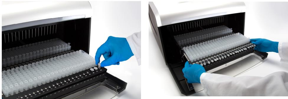
**Figura 45. Extracción de los tubos de elución y de las bandejas de plataforma.**
