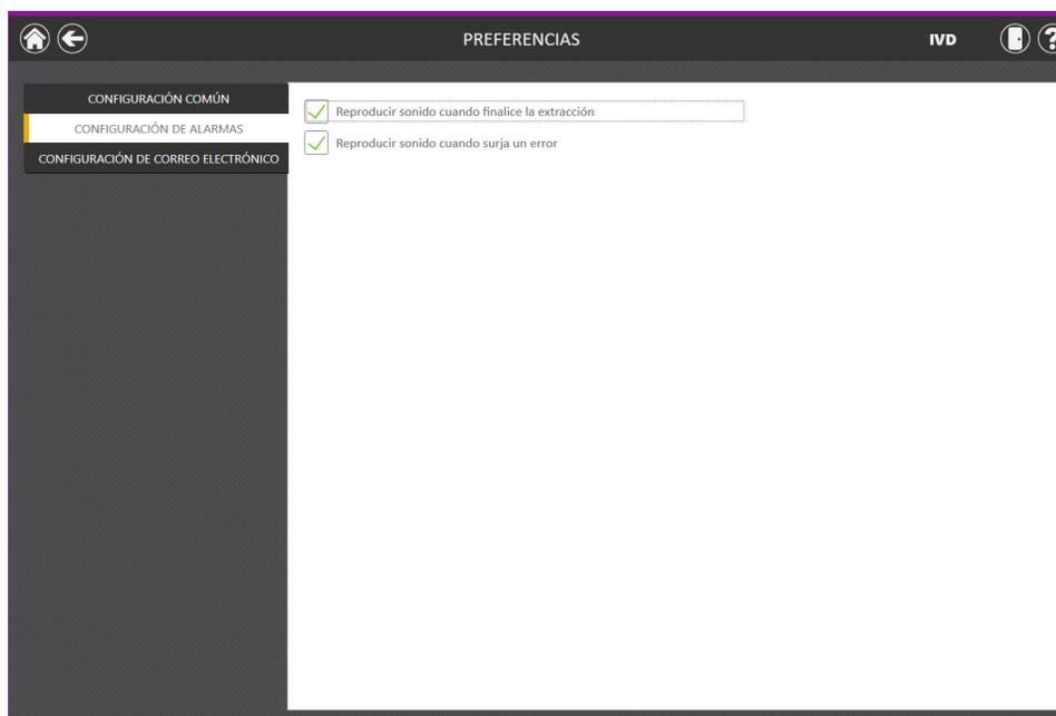
**Figura 27. Pestaña “Configuración de alarmas” de la pantalla “Preferencias”.** En la pestaña “Configuración de alarmas”, el administrador puede especificar si deben reproducirse alarmas audibles al finalizar una ejecución de extracción o al producirse un error.
