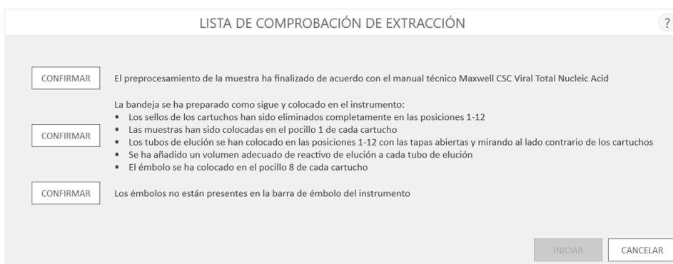
**Figura 38. Pantalla “Lista de comprobación de extracción”.** Esta pantalla indica los pasos que deben realizarse para preparar las bandejas de plataforma antes de procesar las muestras seleccionadas. Los pasos de preprocesamiento individuales no se indican en la Lista de comprobación de extracción y deben realizarse antes de esta fase, conforme al manual técnico del kit que se procese.
