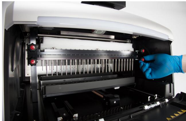
**Figura 62. Colocación de los topes de plástico.** Mueva las barras de imán y de émbolo hacia arriba, y asegure los cuatro tornillos de envío a ambos lados de las barras.
