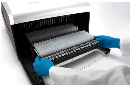
**Figura 39. Coloque los cartuchos en la bandeja de plataforma y presiónelos con firmeza para encajarlos en su sitio.**
