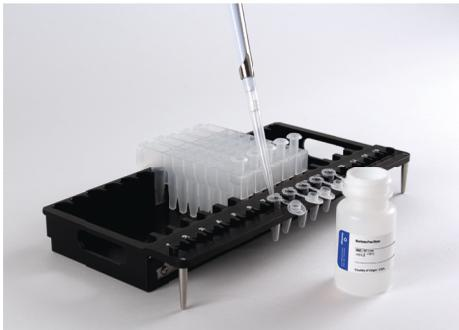
**Figura 2. Preparación y configuración de las bandejas de plataforma.** Se añade tampón de elución a los tubos de elución de la manera indicada. La bandeja de plataforma se muestra desde el Maxwell® CSC Instrument (Cat.# AS6000).
