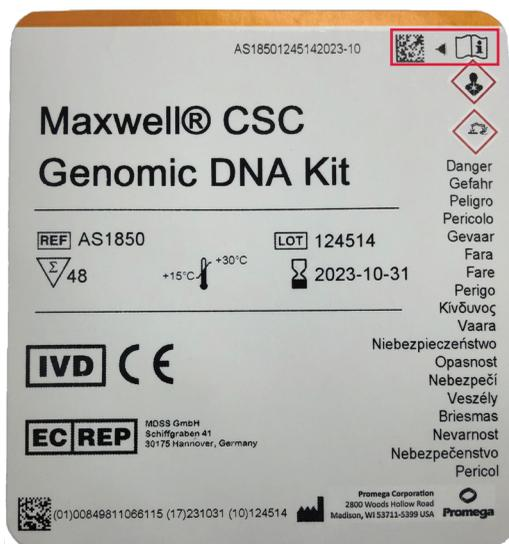
**Figura 3. Etiqueta del kit que indica el código de barras que debe escanearse.** El código de barras que debe escanearse para iniciar una purificación se muestra en el cuadro rojo, en la esquina superior derecha de la etiqueta del kit.
