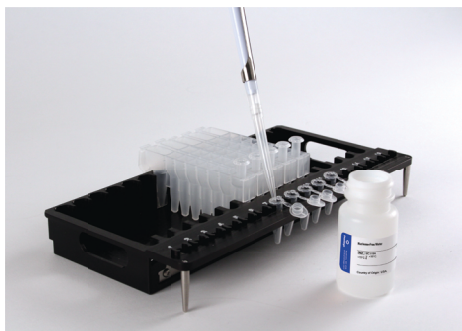
Figura 2. Preparación y configuración de las bandejas de plataforma. Se añade un Elution Buffer a los tubos de elución de la manera indicada. La bandeja de plataforma se muestra desde el Maxwell® CSC Instrument (Cat.# AS6000).
